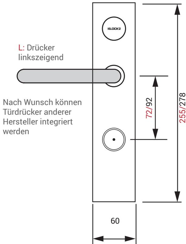
Standardmaße für eine bohrungsfreie und einfache Montage
