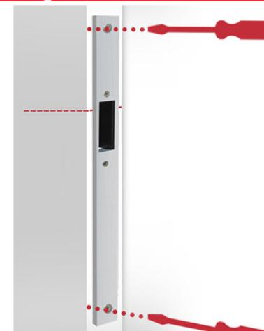
Nach der Positionierung den MTK65 festschrauben.
